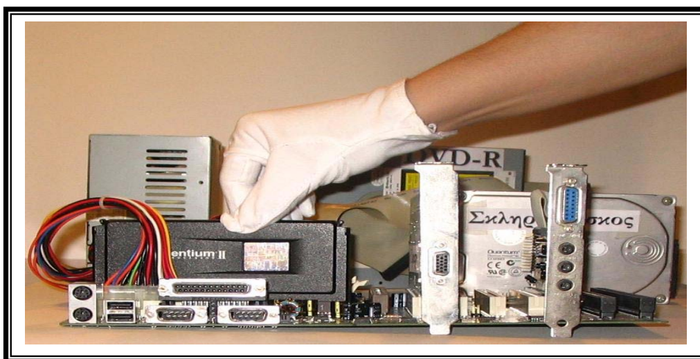
Εικ.8 Η τοποθέτηση του κεντρικού επεξεργαστή απαιτεί λίγη παραπάνω πίεση
