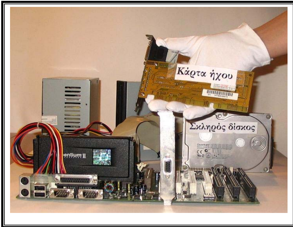
Εικ.5 Εκπαιδευόμενος τοποθετεί στη μητρική κάρτα μια κάρτα επέκτασης (ήχου)
