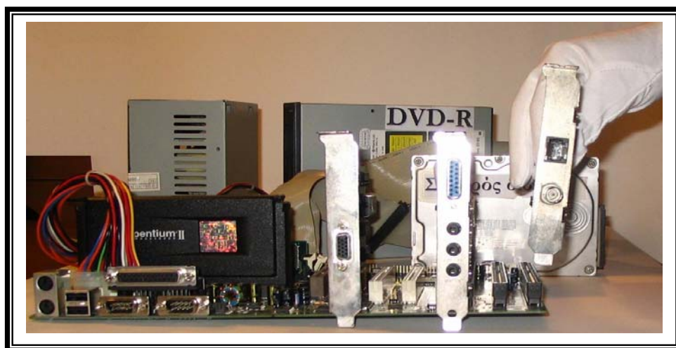
Εικ.6 Εκπαιδευόμενος τοποθετεί στη μητρική κάρτα μια κάρτα επέκτασης (δικτύου)
